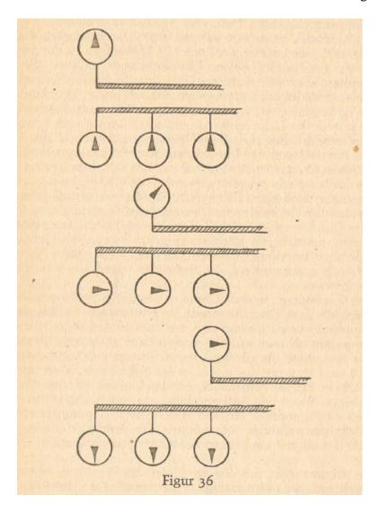
Im unteren Zug sind drei Uhren gezeichnet, die alle 0 Uhr anzeigen. Im oberen Zug, der sich mit der Geschwindigkeit v nach rechts bewegt, ist nur eine Uhr im letzten Wagen gezeichnet, die ebenfalls 0 Uhr anzeigt, wenn die letzten Wagen der beiden Züge sich gerade gleichauf, z.B. bei x=0 befinden.
